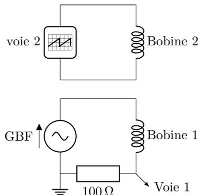
Le premier circuit est alimenté par un GBF à la fréquence  $f = 1\text{ kHz}$ . On branche l'oscilloscope aux bornes d'une résistance  $R = 100\ \Omega$ , la voie 2 de l'oscilloscope est branchée sur la seconde bobine.
