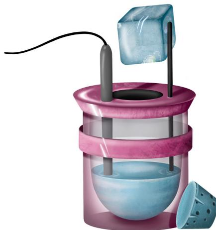
Nous allons mesurer l'enthalpie massique  $h_f$  de fusion de l'eau à  $0^\circ\text{C}$ .
