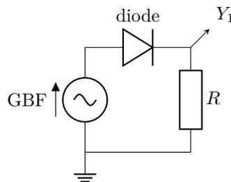
On pourra prendre une résistance  $R \approx 1 \text{ k}\Omega$  mais sa valeur exacte n'a que peu d'importance. La tension fournie par le GBF est sinusoïdale.
