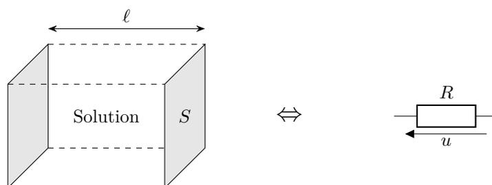
Le conductimètre mesure la conductance (l'inverse de la résistance) de la portion de solution contenue dans la cellule.
