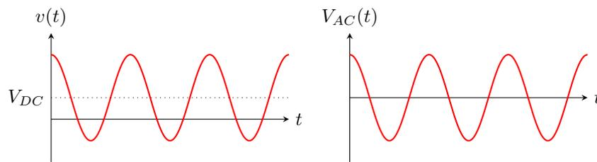
Avec un oscilloscope on peut mesurer en plus la valeur crête à crête (différence entre le maximum et le minimum) et l'amplitude  $V_{max}$  du signal (en générale la moitié de la valeur crête à crête).
