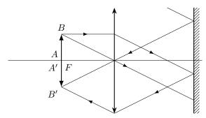
• Appliquer la méthode d'autocollimation pour déterminer la distance focale d'une lentille convergente.
