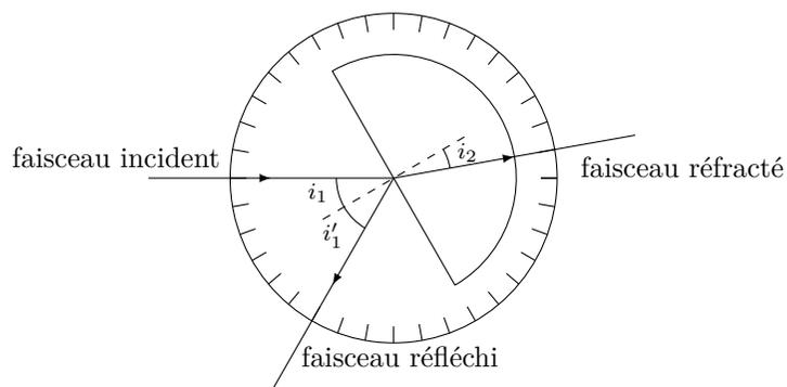
La présence d'un second dioptre de forme circulaire permet d'éviter une seconde réfraction (angle d'incidence nul) et de lire plus facilement l'angle du rayon réfracté.
