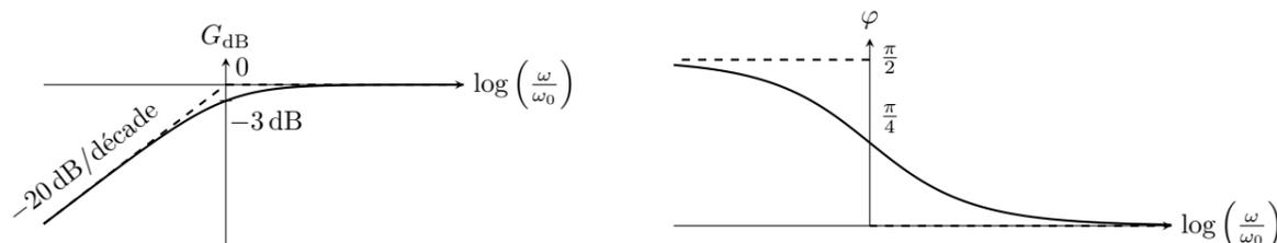
5. Si  $G_{dB} = -3 \text{ dB}$  alors  $|\underline{H}(\omega)| = \frac{1}{2}$  et  $\omega = \omega_0$ . Donc la pulsation de coupure à  $-3 \text{ dB}$  est  $\omega_0 = \frac{R}{L}$ .
