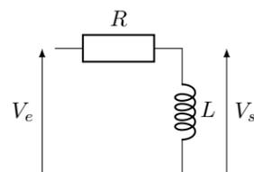
2. À basses fréquences, la bobine se comporte comme un fil, la tension de sortie est alors nulle. À hautes fréquences, la bobine se comporte comme un interrupteur ouvert et la tension de sortie est égale à la tension d'entrée. C'est donc un filtre passe-haut.
