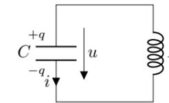
Dans ce circuit on a  $q = Cu$ ,  $u = -L \frac{di}{dt}$  et  $i = \frac{dq}{dt}$ , donc on obtient l'équation différentielle :  $\frac{d^2 q}{dt^2} + \frac{1}{LC} q = 0$
