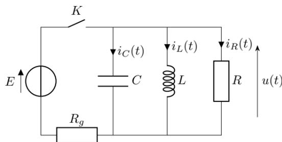
On étudie le circuit RLC parallèle ci-contre. L'interrupteur K est initialement fermé pendant un temps suffisamment long pour que le régime permanent soit atteint. À  $t = 0$  on ouvre l'interrupteur et on observe l'évolution de la tension  $u(t)$ .
