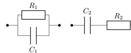
Les deux dipôles suivants sont utilisés dans un circuit en régime sinusoïdal à la fréquence  $\omega$ . Exprimer  $R_2$  et  $C_2$  en fonction de  $R_1$ ,  $C_1$  et  $\omega$  pour que les deux dipôles soient équivalents.
