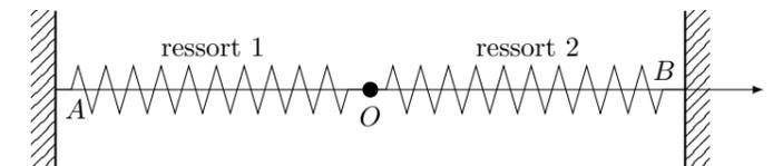
Les deux ressorts sont identiques : même constante de raideur  $k$  et même longueur au repos  $\ell_0$ . Dans la position d'équilibre du système, les longueurs des ressorts sont identiques et valent  $\ell_{eq}$ , et le mobile se trouve à l'origine  $O$  de l'axe. On se place dans le référentiel terrestre, considéré comme galiléen. À  $t = 0$ , le mobile est abandonné sans vitesse initiale d'une position  $x_0$  différente de 0.
