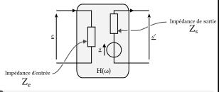
Lorsque l'on met deux filtres en cascade, si  $Z_{s1} \ll Z_{c2}$ , la fonction de transfert totale est le produit des fonctions de transfert des deux filtres.
