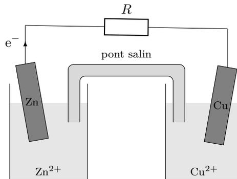
2. Vu les potentiels standards, l'anode est constituée par la plaque de zinc et la cathode par la plaque de cuivre. Les équations qui ont lieu aux électrodes sont
