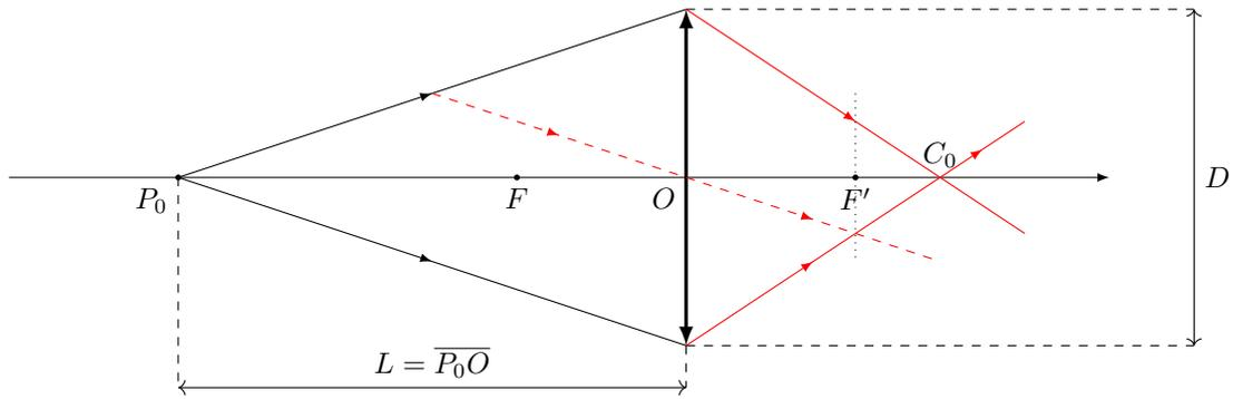
11. On pourrait procéder exactement de la même manière avec le point  $P_1$ , mais, pour changer, on va utiliser un rayon parallèle à celui du bas passant par  $F$ , et sortant parallèle à l'axe optique. Les deux rayons parallèles se croisent, en sortie de la lentille, dans son plan focal objet.
