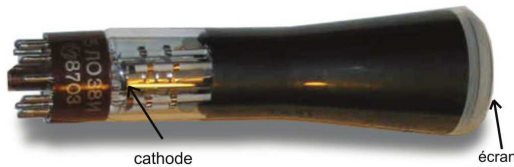
Petit tube d'oscilloscope, de longueur d'environ 20 cm
