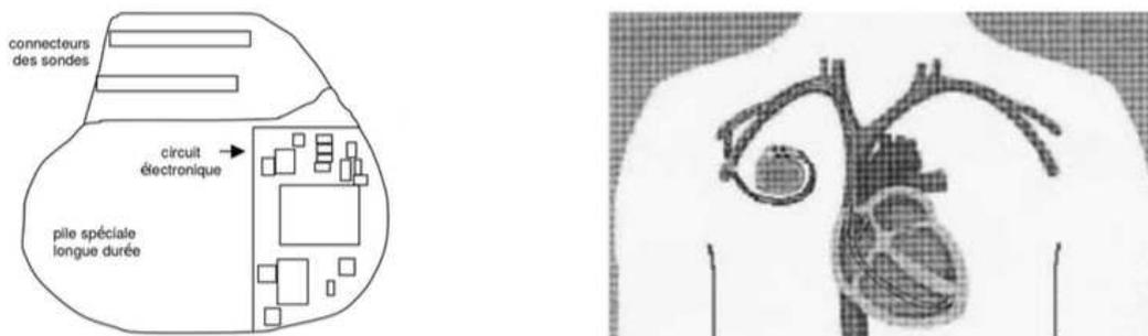
Ce pacemaker est en fait un générateur d'impulsions ; il peut être modélisé par le circuit électrique en dérivation représenté sur figure ci-après, qui comprend un condensateur de capacité  $C = 470 \text{ nF}$ , un résistor de résistance  $R$ , une pile spéciale et un transistor qui joue le rôle d'interrupteur,  $K$ .
