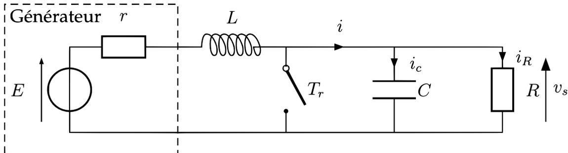
La résistance  $r$  et le générateur  $E$  représentent la modélisation de Thévenin d'un générateur de tension réel. On s'intéresse au régime transitoire qui suit l'ouverture de l'interrupteur à l'instant  $t = 0$ .
