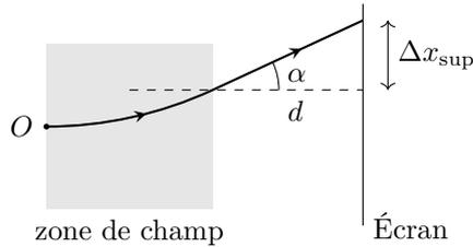
On a alors  $\Delta x_{\text{sup}} = d \tan(\alpha)$ , et  $\tan(\alpha) = \frac{v_{xf}}{v_z} = \frac{v_{xf}}{v_0}$ . On a donc finalement
