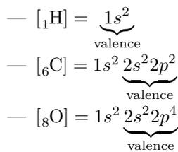
2. La molécule d'acide éthanoïque ( $\text{CH}_2\text{COOH}$ ) possède  $2 \times 4 + 2 \times 6 + 4 = 24$  électrons de valence, donc 12 doublets. On peut proposer la représentation de Lewis suivante :
