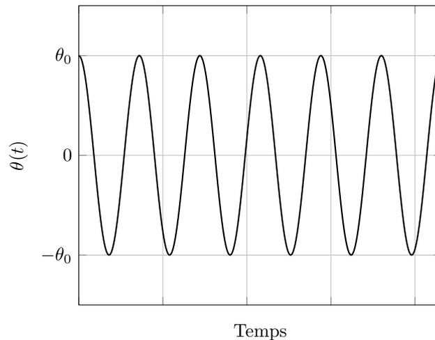
13. Dans ces conditions, la période des oscillations est  $\overline{T_0 = \frac{2\pi}{\omega_0} = 2\pi\sqrt{\frac{a}{g}}}$
