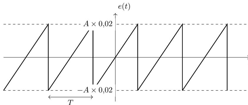
Pour  $T = 10 \mu\text{s}$ , la période est très faible et  $\omega \gg \omega_2$ . Le gain est donc de 1 et le signal est inchangé.
