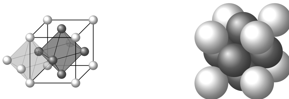
FIGURE 22.10 – Position d'un site octaédrique (en gris) de la structure CFC.
